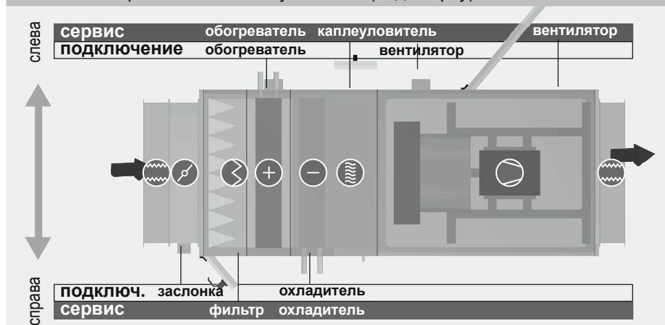
Рис. 1 – сторона исполнения установок (вид сверху)
