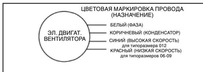
Рис 6а. Соединительная проводка электродвигателей вентиляторов для агрегатов с типоразмерами 015- 060
