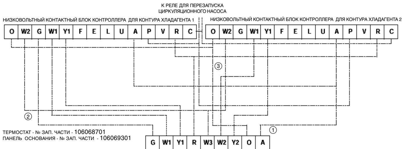
Примечание 1: Опциональное соединение для подключения к аварийному светоиндикатору термостата
